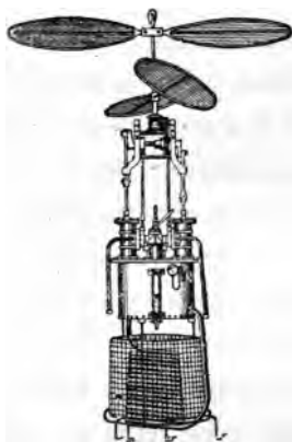
FIG. 30 — Hélicoptère à vapeur, de M. de Ponton d'Amécourt.
